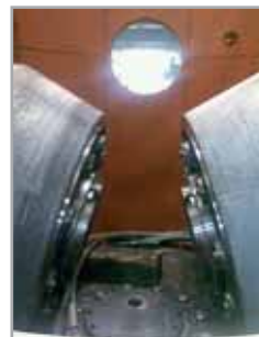
Мелющие бегуны и броньфутеровка мелющей камеры с износостойкой наваркой
