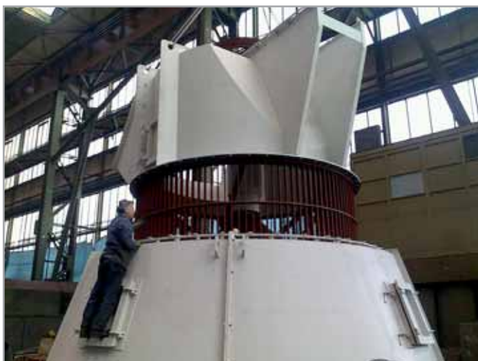
Контрольная сборка верхней части сепаратора мельницы
