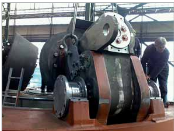
Установка маятников бегунов в подшипники
