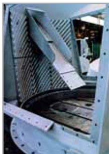
Литая броньфутеровка мелющей камеры
