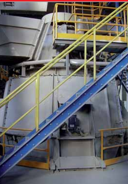
Сепаратор мельницы DTIM 2500 с подачей материала верхом
