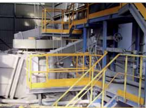
Сепаратор мельницы DTIM 2500 с подачей материала верхом
