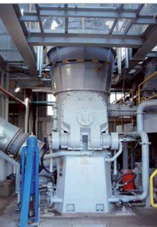
Мельницы КТМУ 1200 для помола нефтекокса и антрацита
