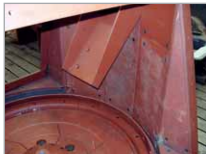
Мелющая камера с броней типа HARDOX и литыми сегментами мелющего диска
