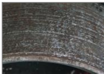
Detail tvrdonávaru na plášti běhounu
