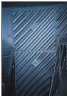
Detail pancéřování mlecí komory
