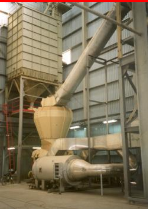
Mlýnice s mlýnem KTM 1600, mletí keramického materiálu (SAE)
