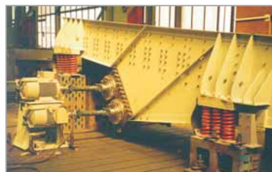
Питатель PVR 1550x6000 – на испытательном стенде завода-изготовителя
