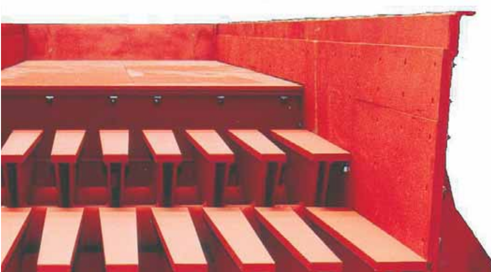
Питатель PVR 1550x6000 – на испытательном стенде завода-изготовителя
