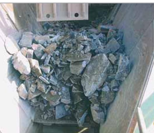
Дозировка бутового камня лотковым питателем ZP 1000x5000
