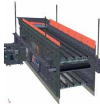
Проект грохота грубой сортировки HT1540 – варианты на опорах и на подвеске, автоматическая система смазки, бронеструерка НХ, металлические и ПУ сита
