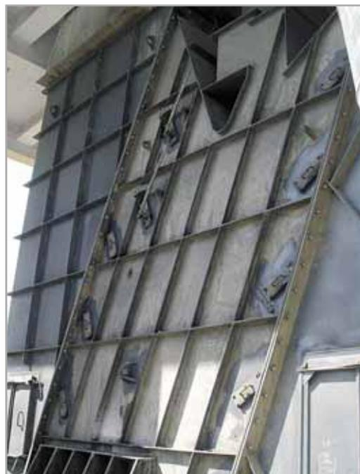
Вид на верхнюю часть сепаратор с входом материала и выходом газа
