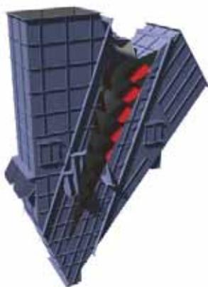
3D модели каскадного воздушного сепаратора KVT
