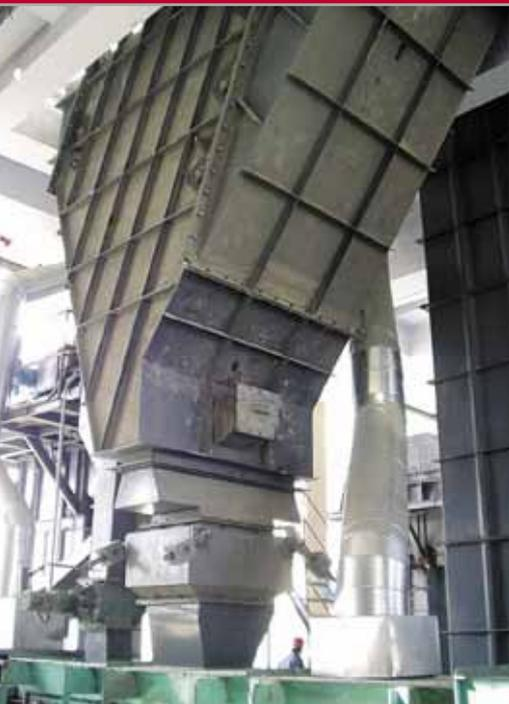
Каскадный воздушный сепаратор KVT 1800 в составе цеха помола цемента мощностью 120 т/час на заводе Qilianhan Cement, Китай. На иллюстрации показана нижняя часть сепаратора с выходом грубой фракции.
