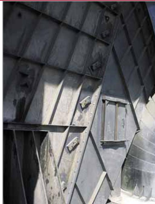
Вид на среднюю часть сепаратора с контрольными отверстиями для упрощения доступа в процесс ухода
