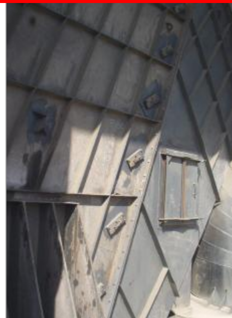
Pohled na střední díl třídiče s kontrolními otvory pro snadný přístup během údržby
