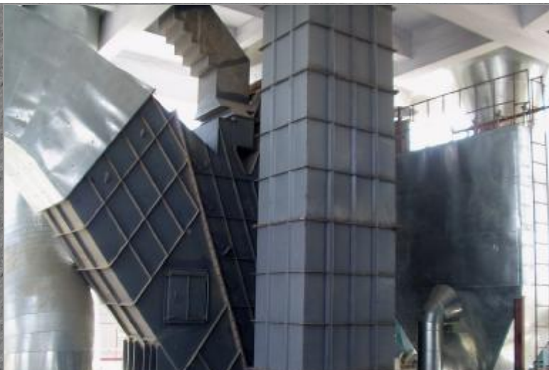
Pohled na horní část vzduchového třídíče se vstupy materiálu a plynu.
