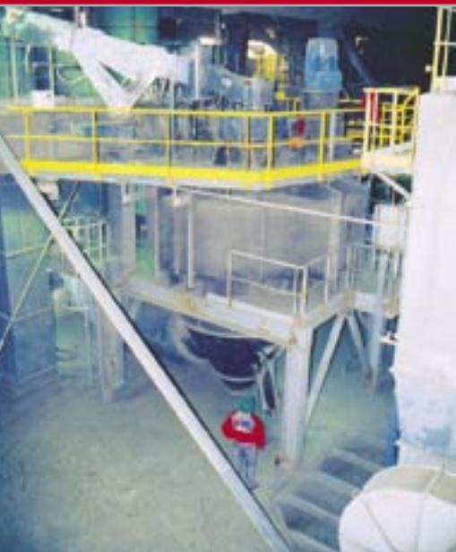
Воздушный сепаратор VTP 2400 в цехе помола цемента 100 тн/час – цементзавод Кижаву, Польша
