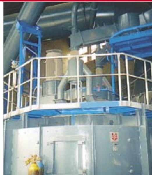
Воздушный сепаратор VTP 2400 в цехе помола цемента 72 тн/час – цементный завод Lukavec, Босния и Герцеговина
