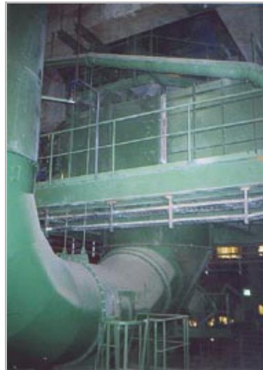
Нижняя часть воздушного сепаратора VTP 2900 с вытяжным воздуховодом в цехе помола цемента 130 тн/час – цементный завод Anhovo, Словения
