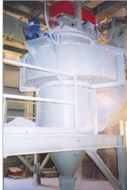
Воздушный сепаратор VTP 1100 в цехе помола известняка 9 тн/час – завод Redipuglia, Италия
