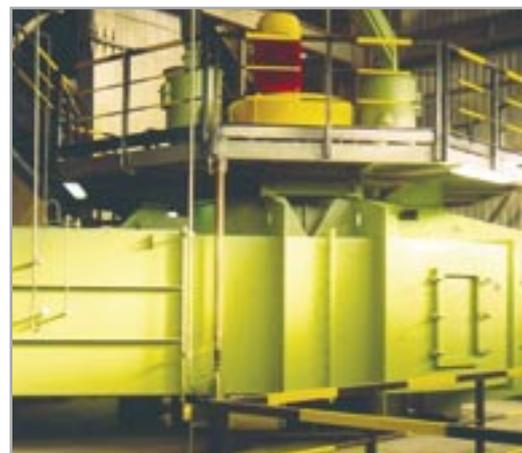
Воздушный сепаратор VTP 2900 в цехе помола цемента 130 тн/час – цементный завод Galatina, Италия
