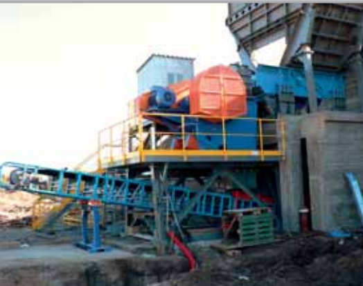
Čelistový drtič DCJ 1100x800 – drcení žuly
