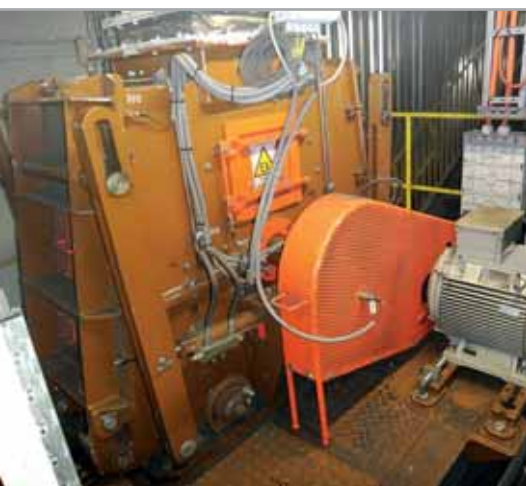
Мельница KMR 0804 дробление угля 8 т/час
