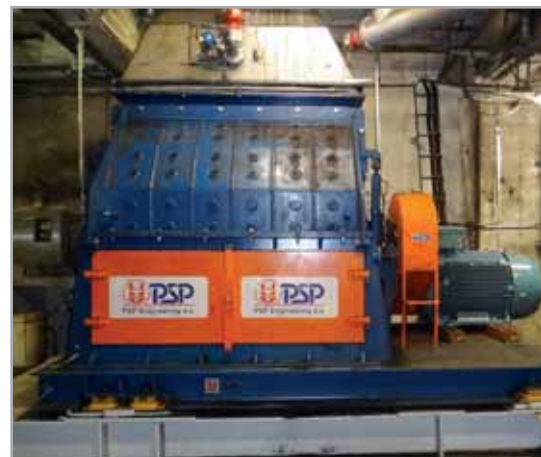
Мельница KMR 1220 дробление угля 250 т/час
