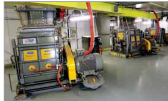
Мельница KMR 0808 дробление угля 3x14 т/час
