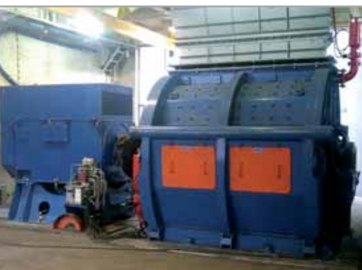
Мельница KMR 1824 дробление угля 350 т/час
