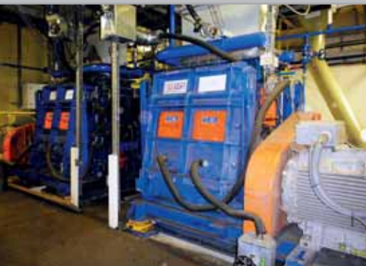
Мельница KMR 0808 дробление угля 2x26 т/час
