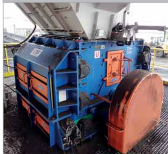
Дробилка KDV 1013 дробление угля 350 т/час
