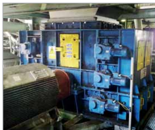
Дробилка KDV 1313 дробление угля 400 т/час
