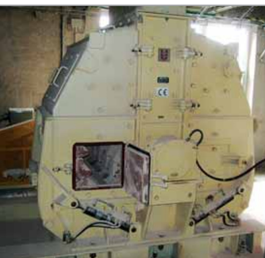
Drtič ODJ 1010-4 drcení vápence 60t/h
