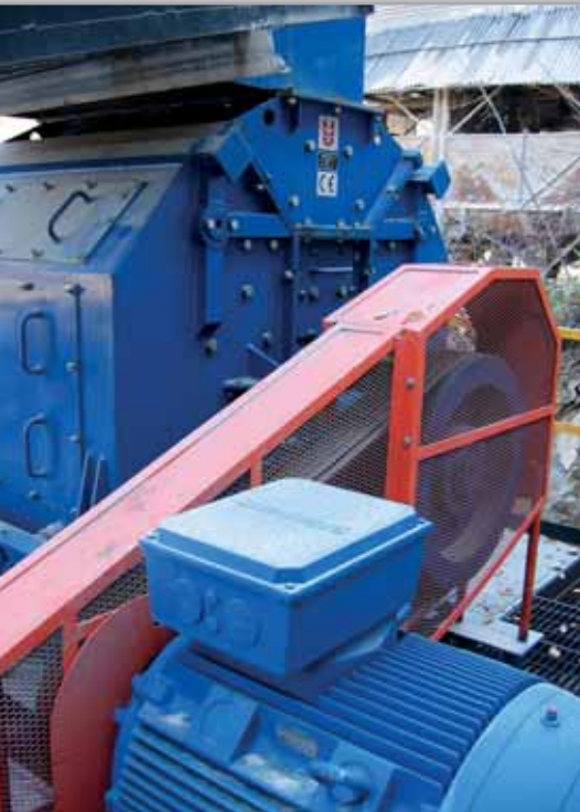
Drtič ODJ 1010-4 drcení vápence 80t/h
