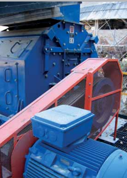
Дробилка ODJ 1010-4 дробление известняка 80 т/час
