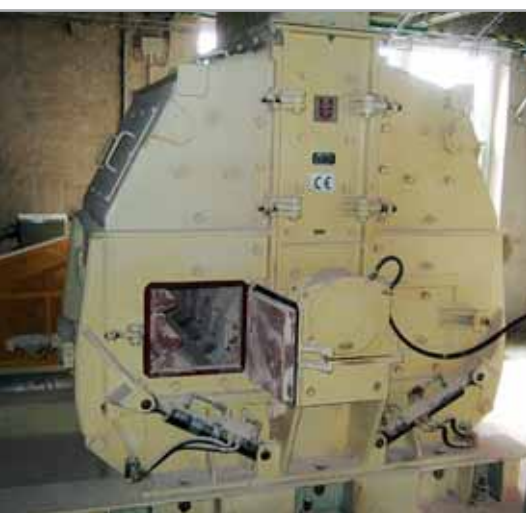
Дробилка ODJ 1010-4 дробление известняка 60 т/час
