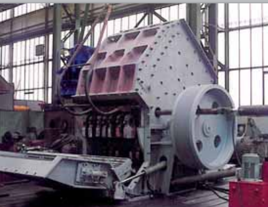
Drtič OKD 1616 ve výrobní hale
