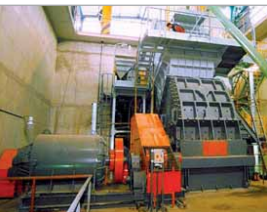
Дробилка ОКД 2020 дробление известняка 450 т/час
