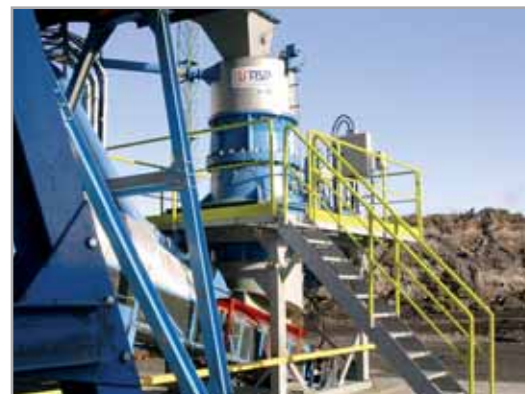
Конусная дробилка KDC 23 HP – дробление шлака
