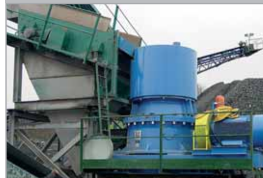
Конусная дробилка KDC 35 GP – дробление андезита
