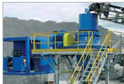
Конусная дробилка KDC 33 JP – дробление гранита
