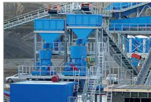
Конусные дробилки KDC 35 FP и KDC 23 HP – дробление ваки
