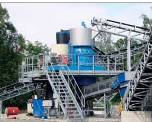
Конусная дробилка KDC 35 FP – дробление вакуи
