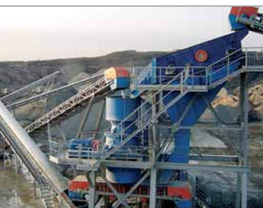
Конусная дробилка KDC 36 GP – дробление базальта
