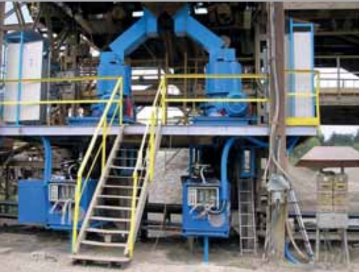
Конусные дробилки KDC 32 JP – дробление щебня
