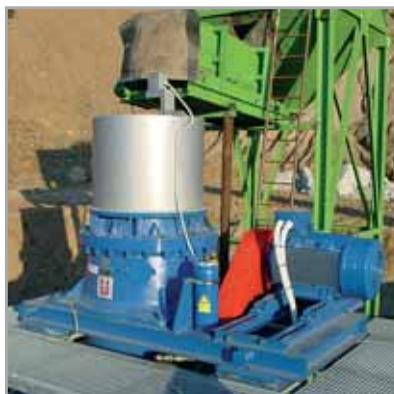
Конусная дробилка KDC 33 FP – дробление гранита
