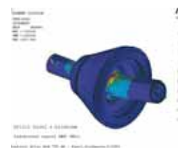
Расчетный анализ конуса с валом для конусной дробилки KDC. Напряжение на объемной модели.
