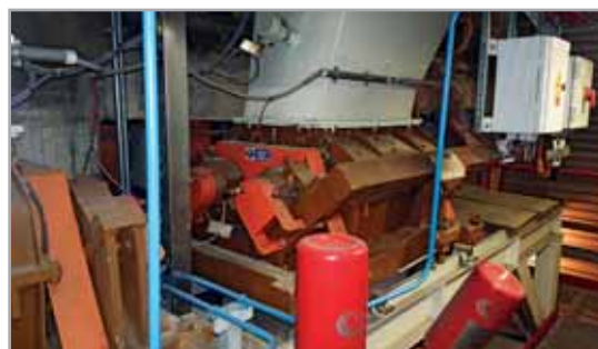
Дробилка DVR 10 дробление угля 10 т/час
