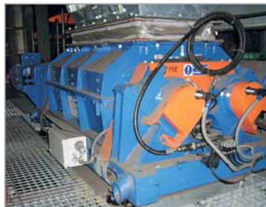
Дробилка DVR 18 дробление шлака 12 т/час
