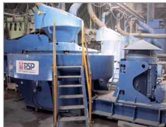
Дробилка ODV 12SM дробление гранита 200 т/час
