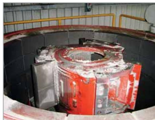
Внутренняя полость дробилки ODV 08SM
