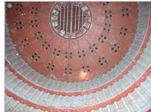
Перегородка с регулируемым потоком материала для оптимального заполнения обеих камер.
