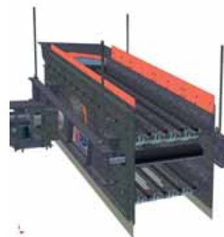
Návrh varianty hrubotřídíče HT1540 – varianta podepřená a zavěšená, automatické mazání, HX pancéřování, ocelová a PU síta
