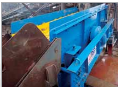
Provoz s hrubotřídíčem HT1540 - třídění pararuly 400 t/hod.
