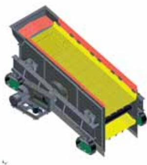
Návrh varianty hrubotřídíče HT1540 – varianta podepřená a zavěšená, automatické mazání, HX pancéřování, ocelová a PU síta
