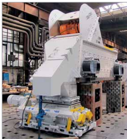
Konečná dílenská montáž třídíče EDT2N1030/2Fe-150°C. Třídění strusky pro 150°C a následném dodrcování drtičem DVR.
