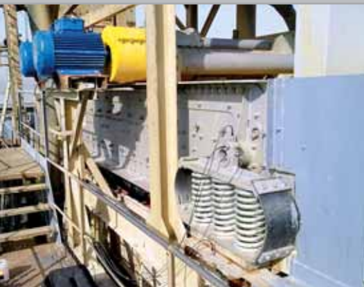
Třídíč EDT2N2160/2PU umístěný na pontonu - třídění šterku za mokra z mořského dna
