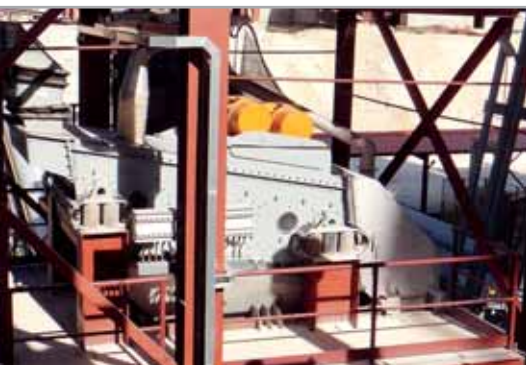
EDT2N1430/2FeK - dávkové třídění vápence do šachtových pecí
