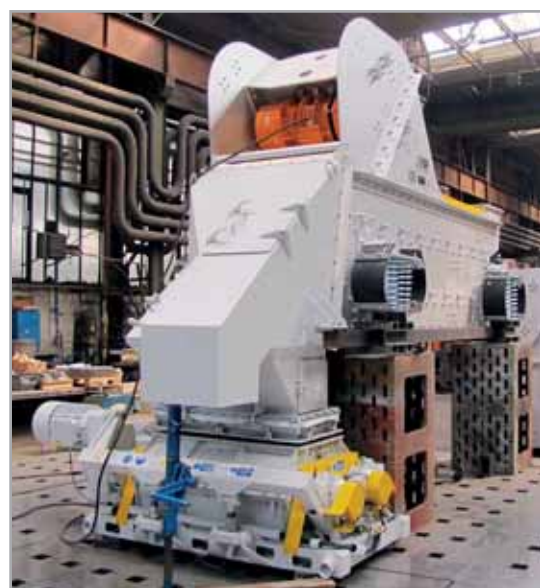
Финальная сборка грохота EDT2N1030/2Fe-150°C. Сортировка шлака при 150°C с последующим дроблением в дробилке DVR.
