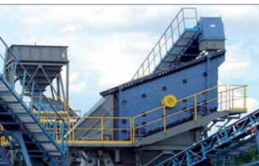
Полумобильная металлоконструкция с грохотом KDT1650/4Fe – сортировка шлака
