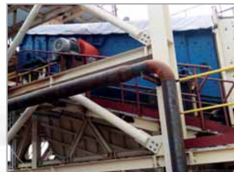
Грохот KDT 2470/2Fe – сортировка золотосодержащей руды
