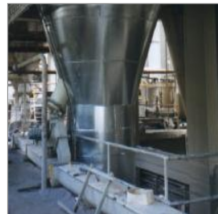
Vzduchový třídíč LTR-R 2500 v mlýnici suroviny 105 t/h – cementárna Rezola, Arrigoriaga, Španělsko
