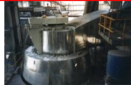
Vzduchový třídíč LTR-R 2500 v mlýnici suroviny 105 t/h – cementárna Rezola, Arrigoriaga, Španělsko
