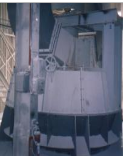
Vzduchový třídící LTR-R 2000 v mlýnici vápna 36 t/h – vápenka Vitošov, ČR
