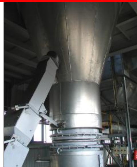
Vzduchový třídící LTRR 1650 v mlýnici koksů 12,5 t/h – OKD Ostrava, ČR
