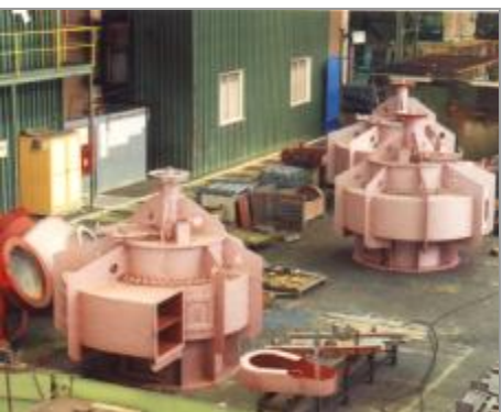
Montáž vzduchových třídíčů VTP 1500 pro mlýnice cementu v Brazílii
