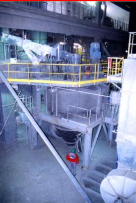
Vzduchový třídíč VTP 2400 v mlýnici cementu 100t/h – cementárna Kujawy, Polsko
