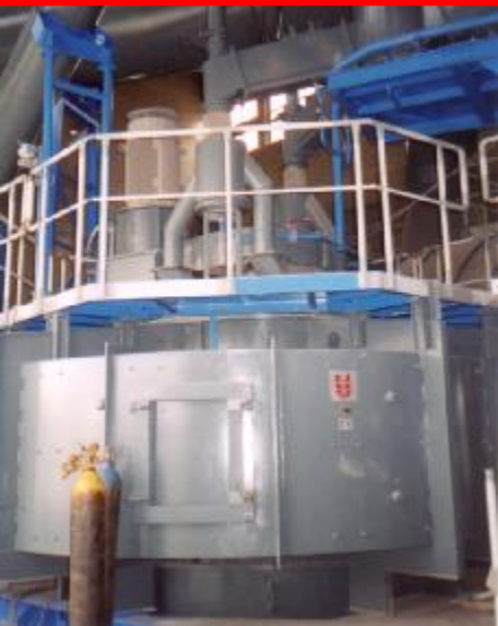
Vzduchový třídíč VTP 2400 v mlýnici cementu 72 t/h – cementárna Lukavac, Bosna a Hercegovina
