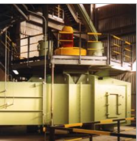
Vzduchový třídíč VTP 2900 v mlýnici cementu 130t/h – cementárna Galatina, Itálie
