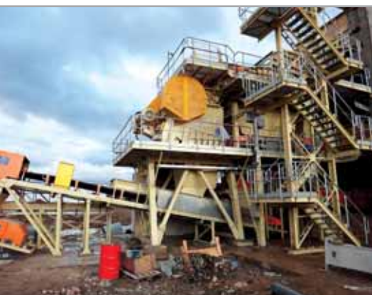
Щековая дробилка DCJ 1400x1120 – дробление известняка
