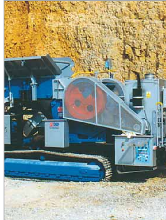
Щековая дробилка DCJ 1031 в составе гусеничной дробильной установки
