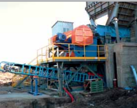
Щековая дробилка DCJ 1100x800 – дробление гранита
