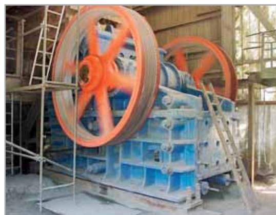
Щековая дробилка V10-2N – дробление габбро
