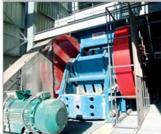
Щековая дробилка DCJ 1600x1250 – дробление гранодиорита
