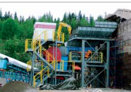
Щековая дробилка DCJ 1200x1000 – дробление гранита
