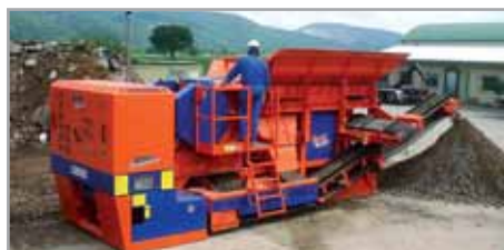
Контейнерная дробильная установка с дробилкой DCJ 1033
