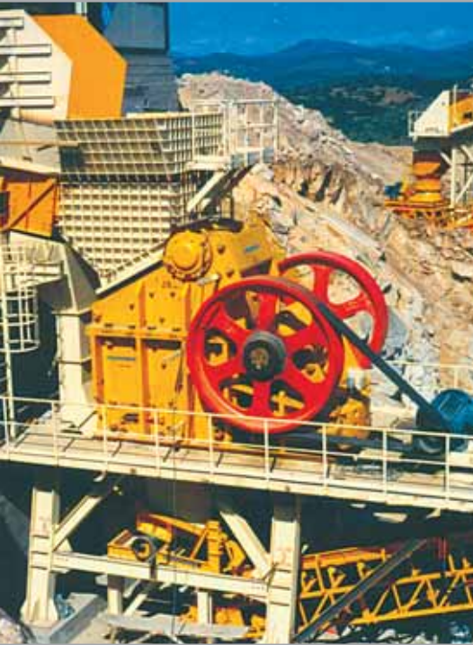
Щековая дробилка DCD 4706 в составе линии дробления гранита.
