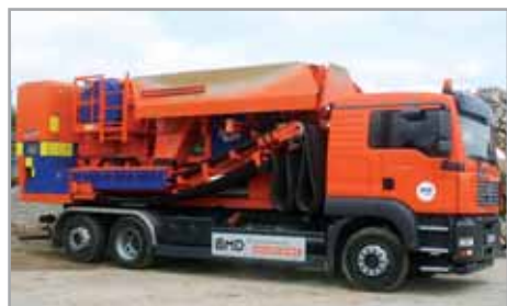
Контейнерная дробильная установка с дробилкой DCJ 1033
