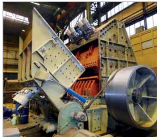
Drtič ODH 2530-13 drcení vápence 1400 t/h
