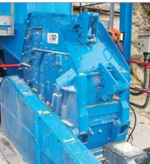
Drtič ODH 0907-12 drcení dolomitu 50t/h
