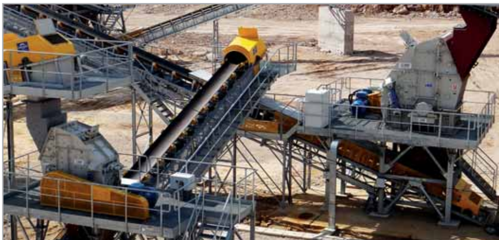
Drtiče ODH 1110-23 a ODH 1616-22 drcení vápence
