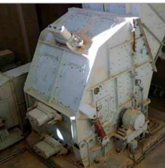
Drtič ODH 1623-13 drcení vápence 700t/h
