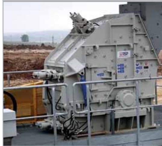
Drtič ODH 1110-23 drcení vápence 120t/h
