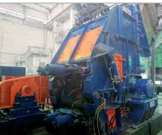
Drtič ODH 1616-23 drcení serpentinitu 300 t/h
