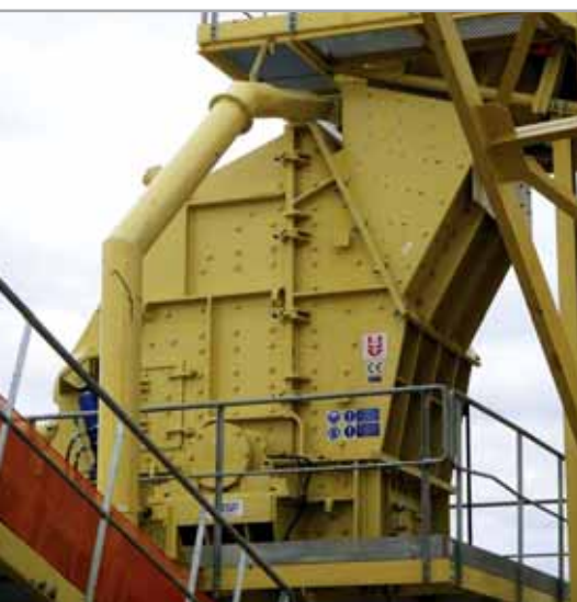
Drtič ODH 1616-22 drcení vápence 500t/h
