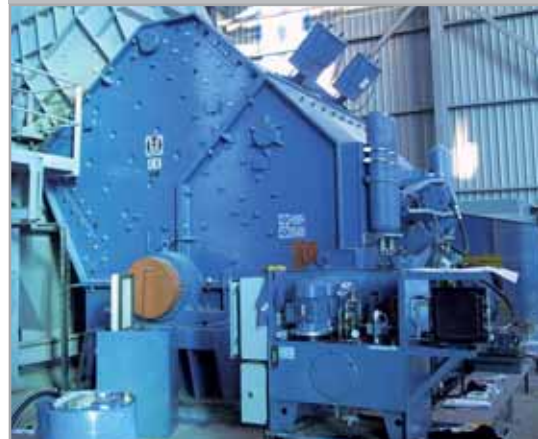
Drtič ODH 2030-13 drcení vápence 1000t/h
