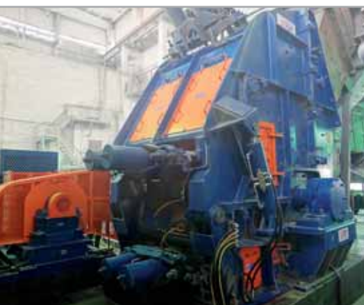
Дробилка ODH 1616-23 дробление серпентинита 300 т/час
