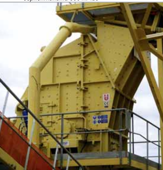
Дробилка ODH 1616-22 дробление известняка 500 т/час
