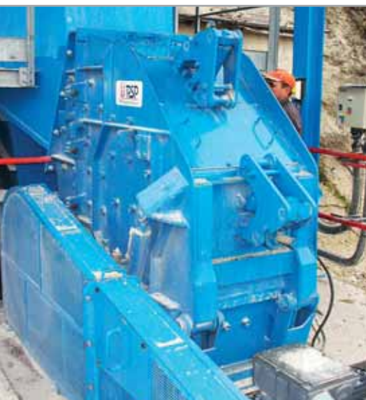
Дробилка ODH 0907-12 дробление доломита 50 т/час
