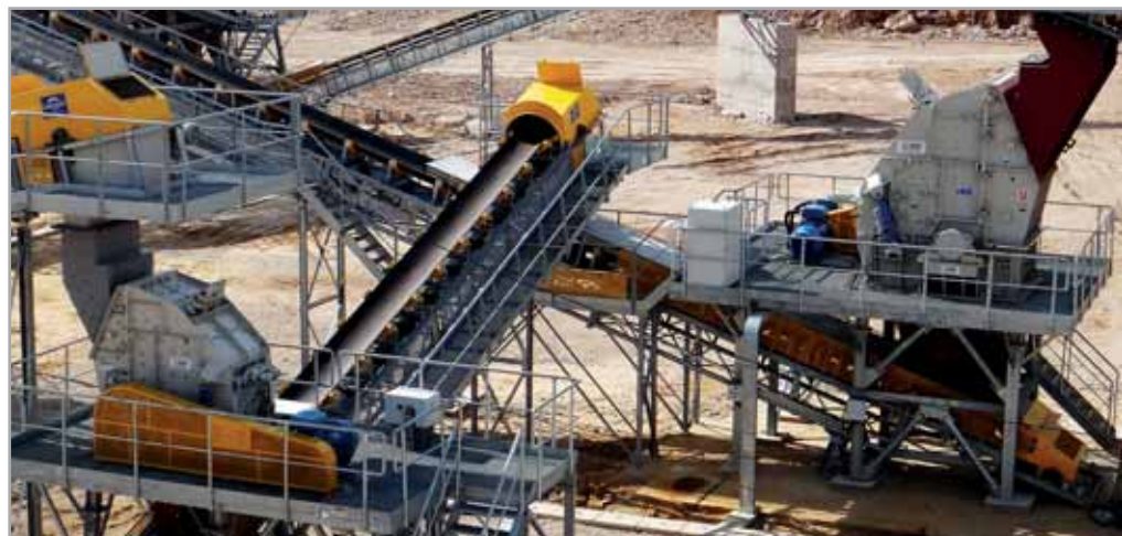
Дробилки ODH 1110-23 и ODH 1616-22 дробление известняка
