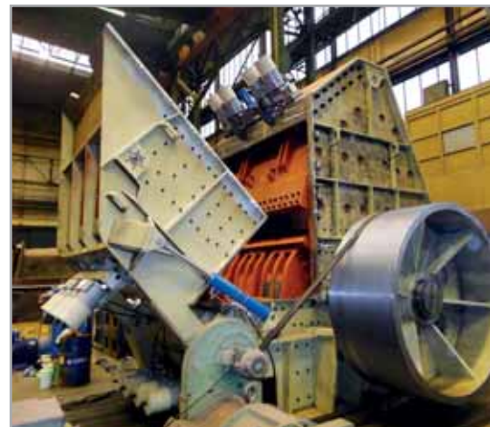
Дробилка ОДН 2530-13 дробление известняка 1400 т/ч
