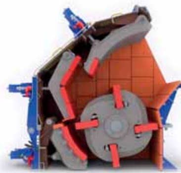
Разрез первичной дробилки ODH с 3 дробящими плитами
