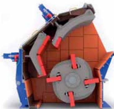
Разрез первичной дробилки ODH с 2 дробящими плитами
