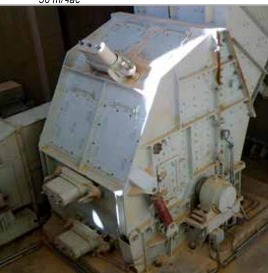
Дробилка ODH 1623-13 дробление известняка 700 т/час
