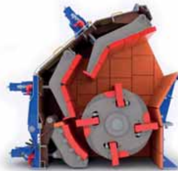
Разрез дробилки ODH 1113-23 с 3 дробящими плитами
