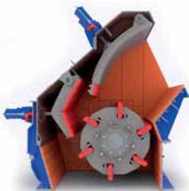
Разрез крупной первичной дробилки ОДН с 2 дробящими плитами
