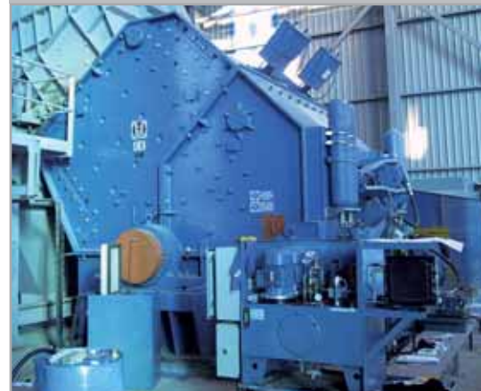
Дробилка ОДН 2030-13 дробление известняка 1000 т/час
