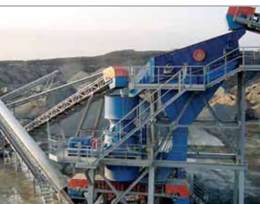
Kuželový drtič KDC 36 GP – drcení bazaltu
