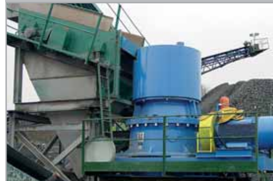
Kuželový drtič KDC 35 GP – drcení andesitu
