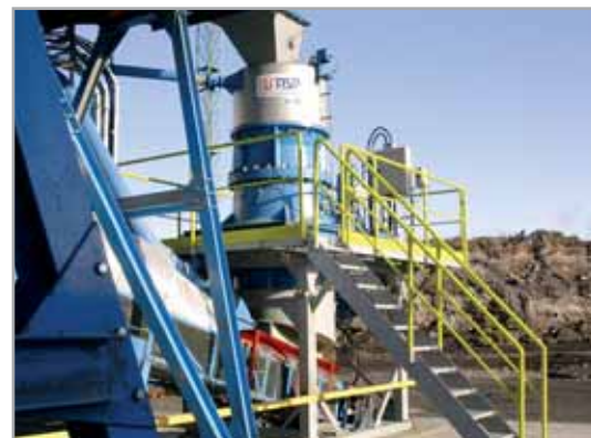
Kuželový drtič KDC 23 HP – drcení strusky
