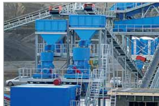
Kuželové drtiče KDC 35 FP a KDC 23 HP – drcení droby
