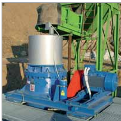
Kuželový drtič KDC 33 FP – drcení žuly
