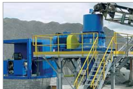
Kuželový drtič KDC 33 JP – drcení spilitu
