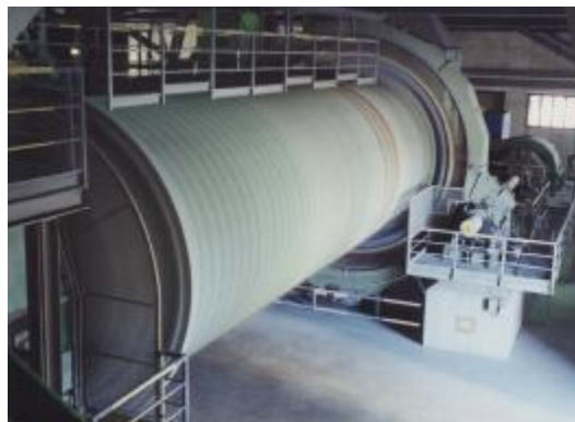
Příklady cementových mlýnů s krčními ložisky
