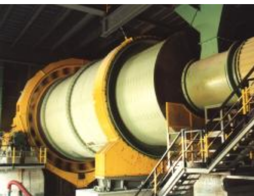
Mlýn pro mletí suroviny Ø 5,4x11 m se sušicí komorou.
