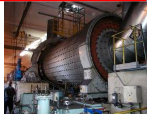
Pneumatický mlýn pro mletí koksu Ø 3,4 x 7 m
