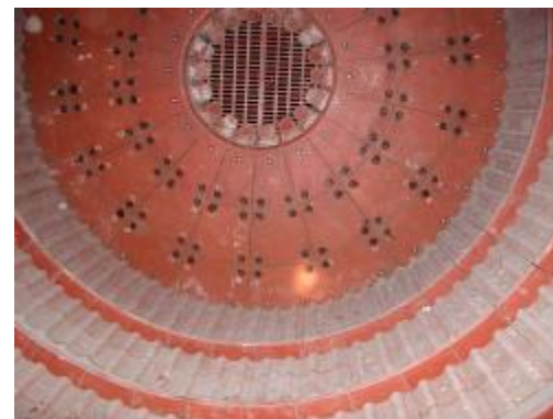
Mezistěna s říditelným průtokem meliva pro optimální zaplnění obou komor melivem.
