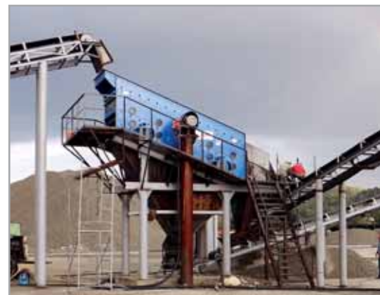
Třídíč KDT1650/3Fe - třídění těžného štěrku
