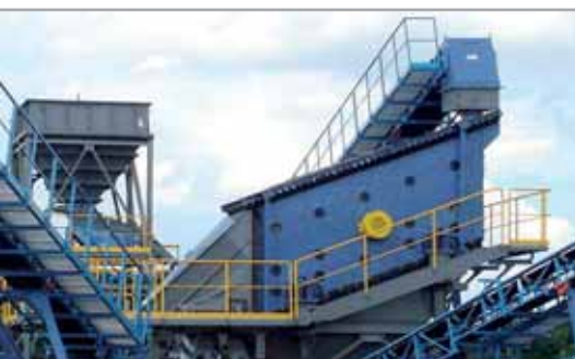
Semimobilní ocelová konstrukce třídíčem KDT1650/4Fe - třídění trusky
